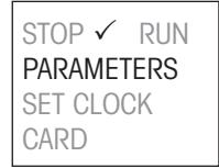
In diesem Untermenü können die Spül- und Reinigungszeit angepasst werden. Mit der «▲» oder «▼»-Taste (Mitte) können die Zeiten der Reinigung und Spülung in der SPS gefunden und eingestellt werden.
