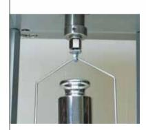
オプションのアダプタを使用 すると、計量モジュールの下 方に吊り下げた状態で荷重を 計量できます。この場合も、あ らゆる方向に対して過負荷保 護が機能します。
