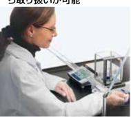
WXT計量モジュールには、粉 体塗装が施され、特に手動計 量に適しています。省スペース で限られたスペースでの計量 に適しています。あらゆる方 向から取り扱い可能であるた め、配置と操作の両方が重視 されるときに高い柔軟性を発 揮します。
